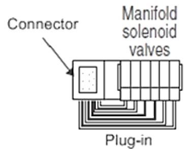
Este sistema consiste en unir mediante cable la bobina de cada válvula, una por una, con la unidad de salida (pins) del terminal conector. Cada válvula usada necesita estar conectado al terminal conector (método convencional)
