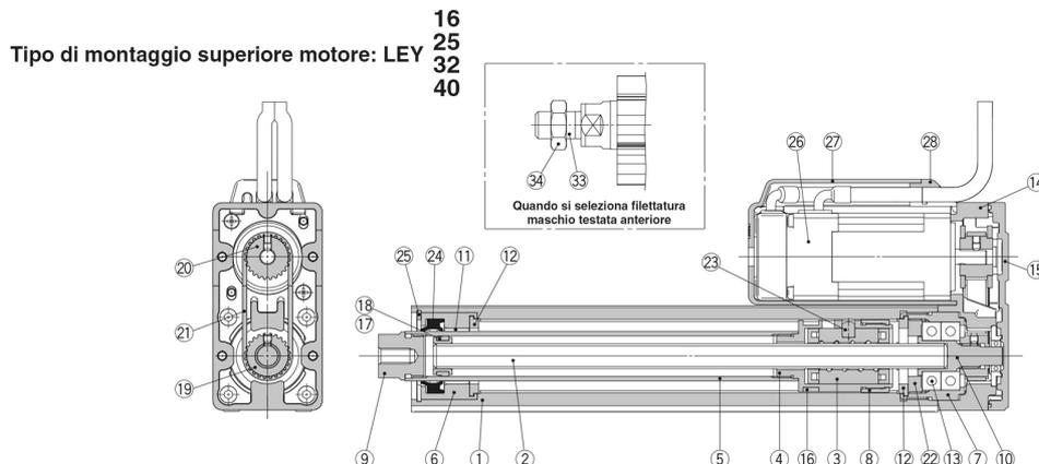
Tipo parallelo/superiore motore
