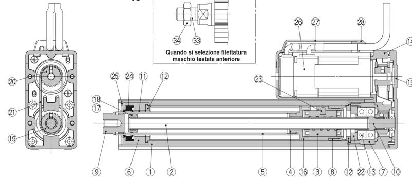
**Tipo parallelo/superiore motore
