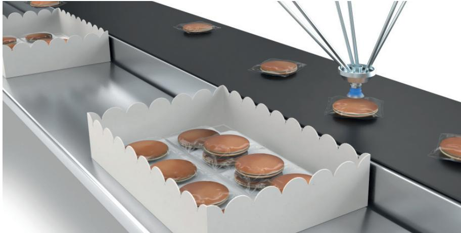
L'adsorption de pièces conditionnées par film souple avec des robots spider haute vitesse dans l'industrie alimentaire nécessite une jupe de ventouse qui puisse s'adapter. Pour cela, utilisez nos ventouses conformes FDA – [Série ZP3P](#)
