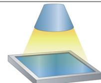
Un simulador solar comprueba el rendimiento de salida, y los defectos, en una revisión final.
