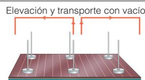
El módulo se transporta al siguiente paso del proceso.
