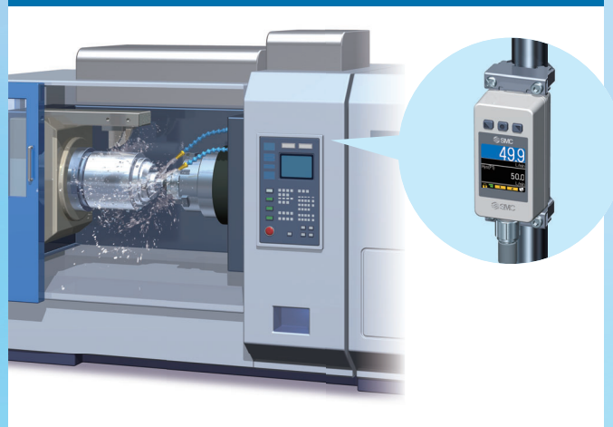
Gestion du refroidissement machine
